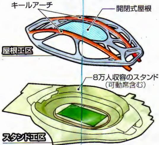
2020年東京五輪の主会場となる新国立競技場の建設には、技術的難題が山積している。独創的な外観デザインを支える巨大なアーチ構造や開閉式屋根(遮音装置)などはいずれも世界初の難工事という。事業主体の日本スポーツ振興センター(JSC)は「ノウハウを生かしたい」と、実施設計の段階で施工会社を選ぶことを決めたが、設計を修正しない限り、建設費は膨らみそうだ。(森本智之)＝核心③面
